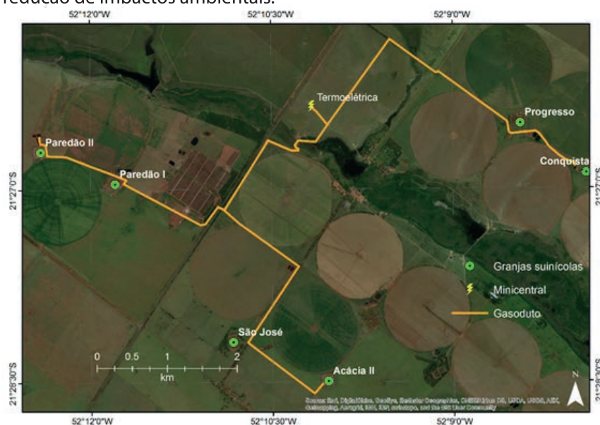
Figura 1. Espacialização das granjas suínolas e do gasoduto para transporte de biogás até a central geradora de energia da Fazenda Córrego Azul, em Brasilândia, MS.
